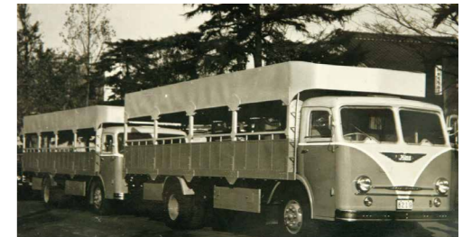
日本で初めてアンダーフロア車を二段車に改造。 ホンダのドリーム号を28台積載「マンモス」
